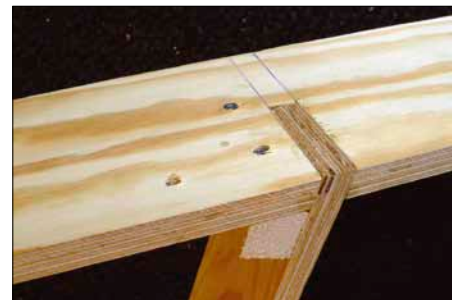
Sammenføyninger: Seksjonsdelene tappes ut og føyes sammen som vist. Først et sagsnitt på hver side, og så tappjern for å løsne trebiten. Vi bruker en drasag av japansk type til dette.
