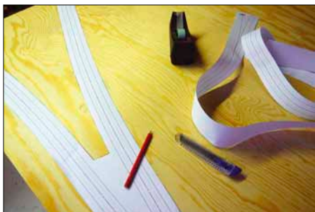
Plott: Tilskåret plott tegnes av og skjæres så ut med stikksag i en 12 mm kryssfinerplate.
