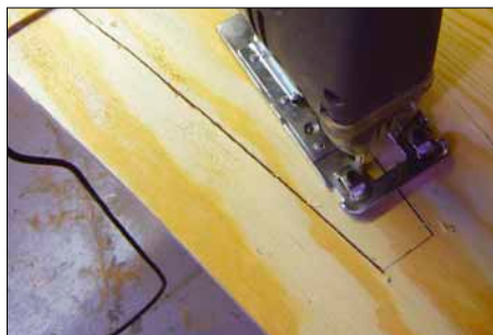
Plott: Tilskåret plott tegnes av og skjæres så ut med stikksag i en 12 mm kryssfinerplate.
