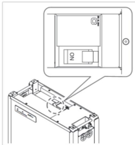
7. Die mittlere Einschalttaste am Speicherwechselrichter drücken.
