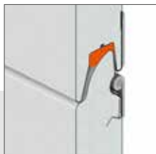
Paneel von 40 mm Stärke U=1,12 \text{ [W/m}^2\text{K]}^*
