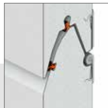
Paneel von 60 mm Stärke. U=0,9 \text{ [W/m}^2\text{K]}^*
