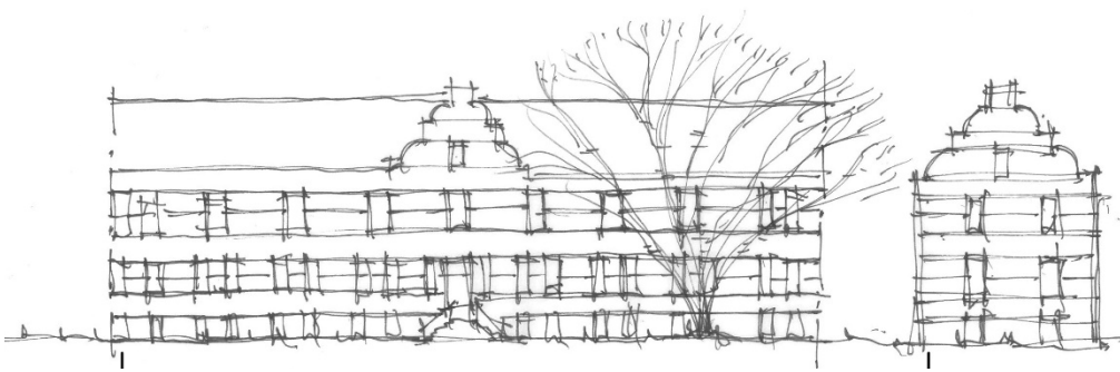
Figur 12 – Principper for de eksisterende bygninger med facade i tegl med fast pille-vindue motiv, dog med diskrete variationer og vandrette teglbånd. Princip for gavlmotiv med vandrette markerede teglbånd og høje vinduer.
