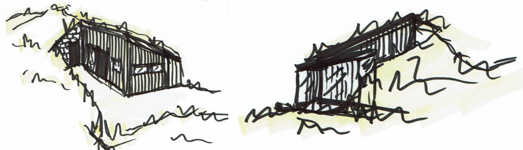
DELVIS NEDGRAVD FASADE MOT FJELLET (ULIKE ALTERNATIVER)
