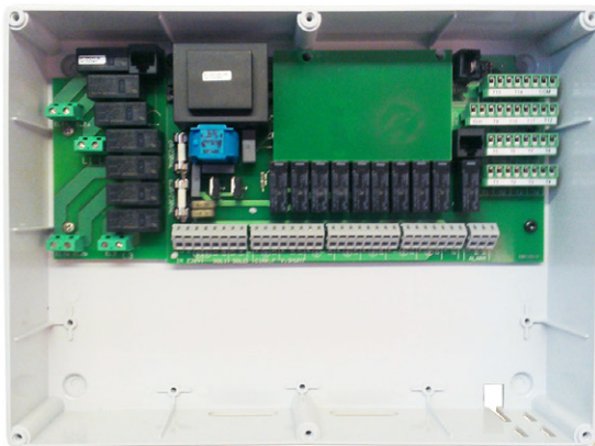
Kopplingslåda med kretskort samt tillbehöret reläkort elpatroner monterat
