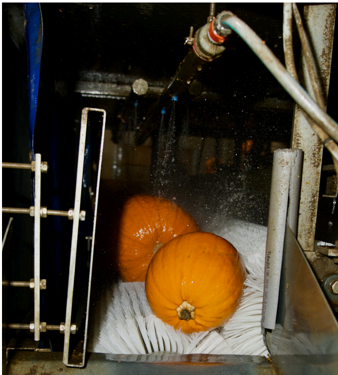
Med Anolytechs system för desinficering av vattnet som används för att tvätta pumporna försvinner problemen med mögelsporer.
