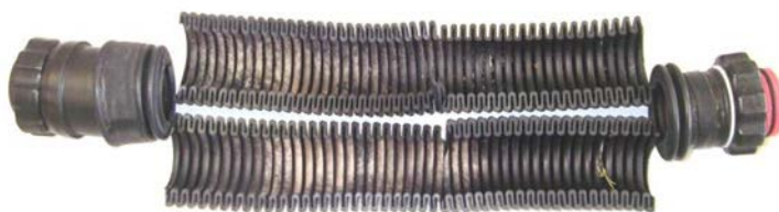
Figuur 2 opengewerkte ademslang van een LARVII
