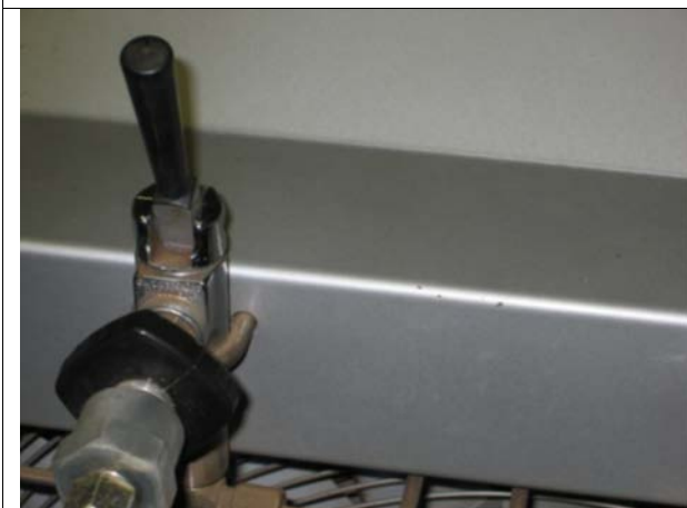
Haal vervolgens de hendel van de overeenkomstige slang op de compressor over zodat druk op de slang komt.
