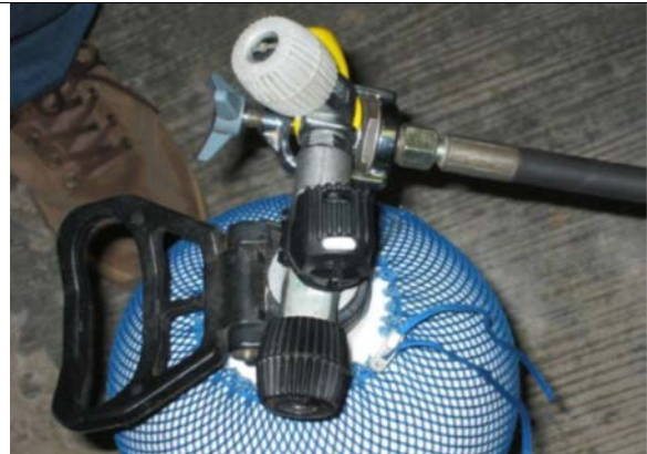
Sluit de slang aan op de fles met de overeenkomstige aansluiting
