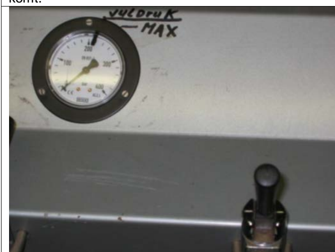
Haal vervolgens de hendel van de overeenkomstige slang op de compressor over zodat druk op de slang komt.
