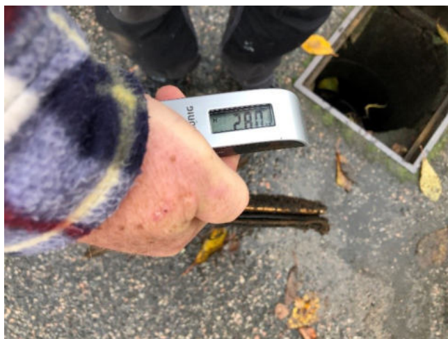
Foton ovan: I samband med att vi tar upp filtren väger vi dem. Filterplats 1 tv och 2 th. Upptagning av filter gjordes 20 november 2019.
