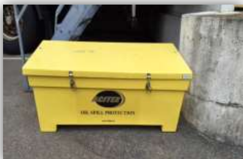
Bild 18. Saneringslåda "Gul låda" som innehåller: Tätningsmatta, absorbent, hydrofob filt/duk, läns och en miljöskyddskudde.
