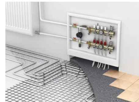
Eksempel på gulvvarme
