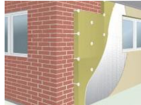
Princip for udvendig isolering
